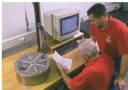
Provádění těsnostní zkoušky
